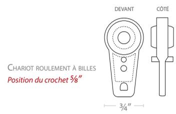
**i** La position du crochet est mesurée à partir du dessous du rail.
